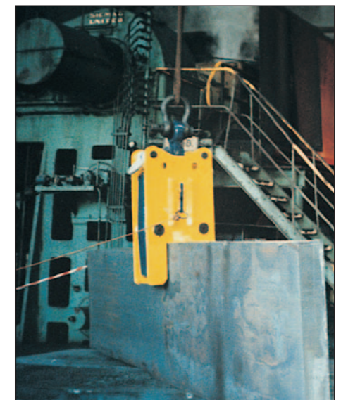
Garra con control remoto para placas, resistente al calor, para temperaturas hasta 1320 °C IPSL
