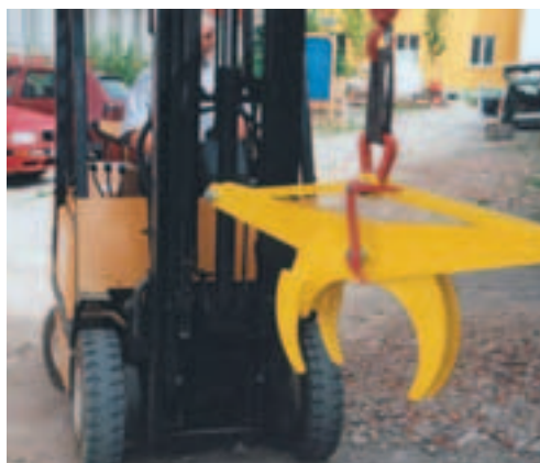
Garra de 3 brazos Tipo RGD 3-arms-round-material-grab RGD
