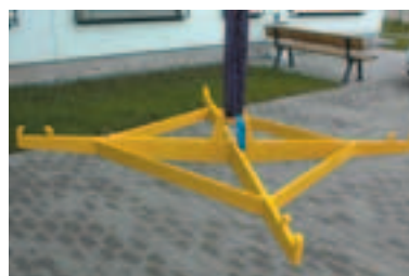
Balancín para grandes bolsas de Poliester cross beam for big - bags
